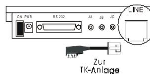
Mit Hilfe eines kleinen Schraubenziehers können Sie eine Feinabstimmung des Ansagepegels der Ansage auf der Telefonleitung durchführen. Wenn die Ansage zu leise sein sollte, versuchen Sie es mit einer neuen Aufnahme indem Sie etwas lauter in das Mikrofon sprechen und/oder die Lautstärke des Wiedergabegerätes etwas höher stellen. Bitte beachten! Die Lautstärke des eingebauten Lautsprechers ist nicht einstellbar.
