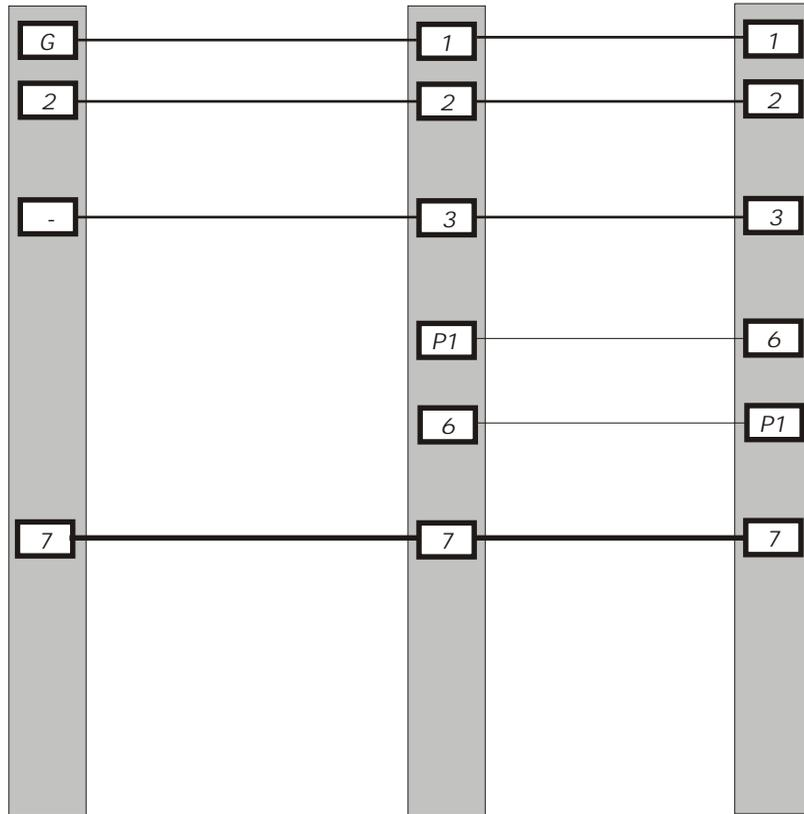
In den Haustelegone PT 520 Brücke W1 unterbrechen. In den Haustelegone PV 260 Drahtbrücke zwischen den Klmemen 3 und 7 entfernen.
